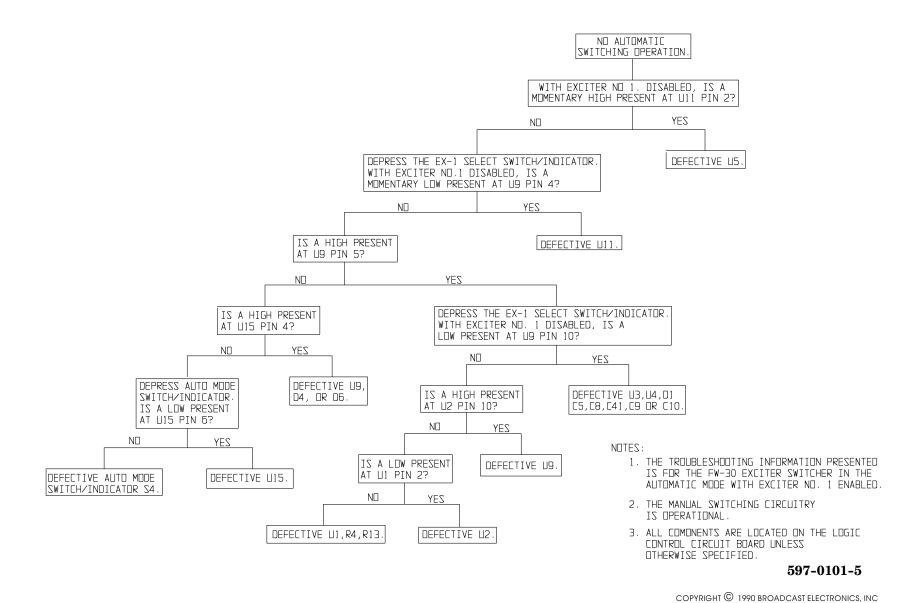
FIGURE 5-2. TROUBLESHOOTING TREE, NO AUTOMATIC SWITCHING OPERATION
