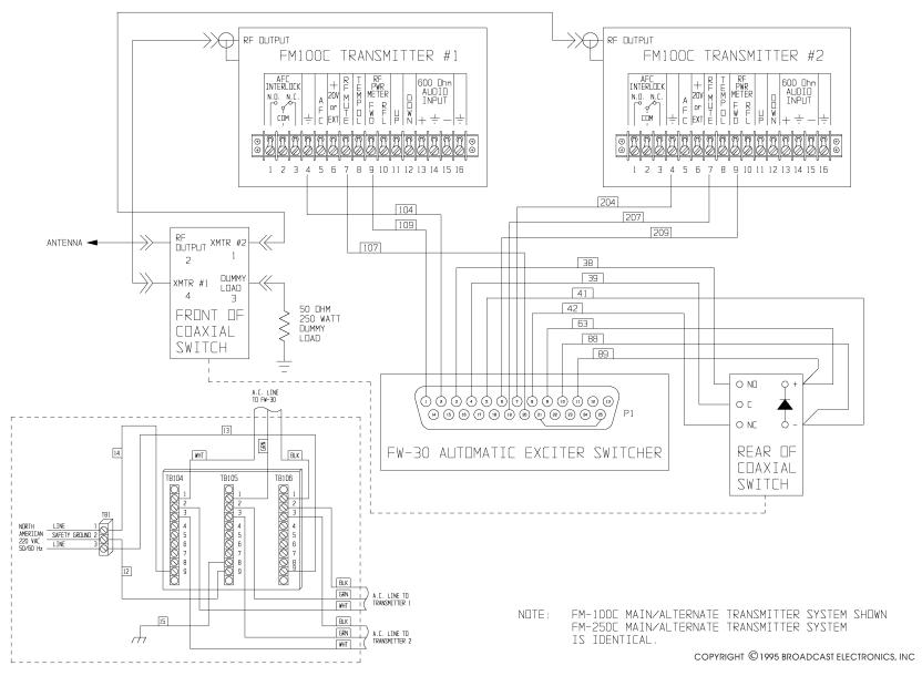
FIGURE 7-7. OVERALL SCHEMATIC, FM-100C/FM-250C EXCITER SWITCHER SYSTEM
